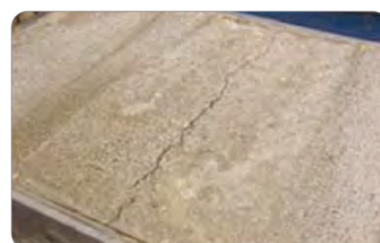
Typisch scheurpatroon in standaard beton
