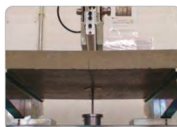
Test buigsterkte op 3 punten op een plaat van 600 x 600 x 50 mm
